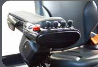
신형 핑거팁 컨트롤러: 인체공학적으로 설계된 편안한 자세로 정교하고 섬세한 컨트롤을 구현하여 작업 효율성이 향상됩니다. (옵션사양)
