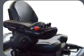
신형 핑거팁 컨트롤러: 인체공학적으로 설계된 편안한 자세로 정교하고 섬세한 컨트롤을 구현하여 작업 효율성이 향상됩니다. (옵션사양)
